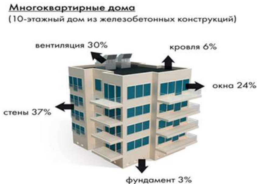
Рис. 5. Схема основных теплопотерь многоквартирного жилого дома
